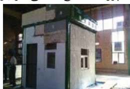
شکل ۲- (مدل میز لرزان) دیوار پرکننده راست با بازشو و نمای سیمانکاری (موازی زلزله) و دیوار پرکننده چپ با بازشوی در و پنجره (عمود بر جهت زلزله)
