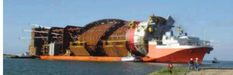
صفحات هیو به هم متصل می‌شوند. شایان ذکر است که هر یک از این سیلندرها دارای ذخیره بیانسی مجزایی جهت ایجاد بالاست در سازه هستند. این نوع در مقایسه با حالت تک استوانه‌ای از نظر اقتصادی و ساخت، مناسب‌تر است. در شکل ۴ سکوهای اسپار نصب شده در عمق ۵۸۰ متر تا ۱۸۰۰ متر نشان داده شده است.
