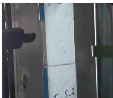
شکل ۹- آزمایش مقاومت کششی مش توری پلاستیکی [۶] شکل ۱۰- عدم جدا شدن قطعه پس از گسیختگی [۶]
