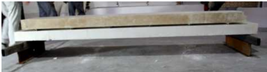
شکل ۸ تحمل دو برابر وزن دیوار در خمش خارج از صفحه
