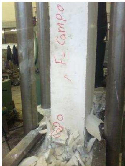
شکل ۵ رفتار مطلوب (لهیدگی پایه) در فشار بر روی پانل
