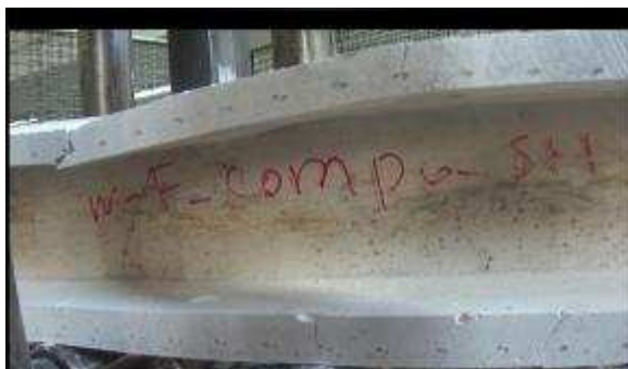
شکل ۲ شکست مطلوب شکل‌پذیر در خمش در تیر دارای مصالح تسلیم در بال و جان
