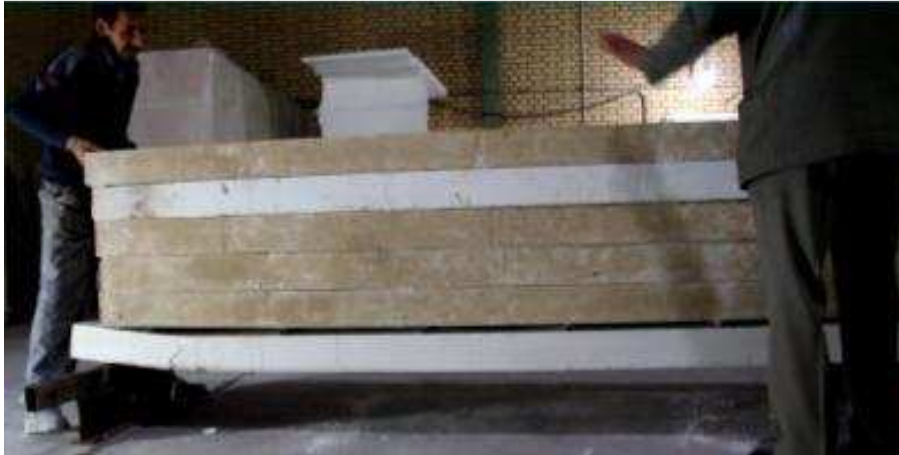
شکل ۱۰ شروع شکست در هنگام قرار دادن قطعه ششم
