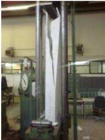
شکل ۴ رفتار نامطلوب فشاری در پانل در صورت عدم وجود تسلیح (توجه شود در محصولات ایزی وال این تسلیح وجود دارد).
