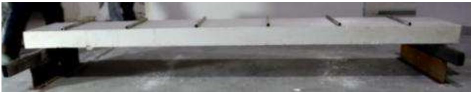
شکل ۷ چیدن لوله برای شبیه سازی بار گسترده یکنواخت در طول پانل (توجه شود که در این تصویر دیوار وزن خود را در خمش خارج از صفحه تحمل می کند.)
