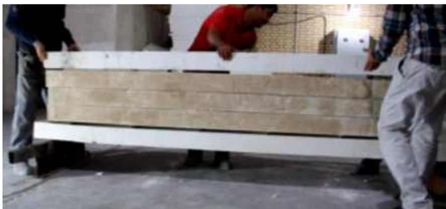
شکل ۹ تحمل پنج برابر وزن دیوار در خمش خارج از صفحه
