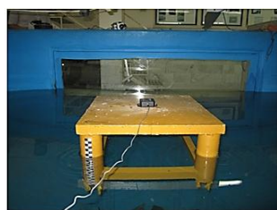
شکل ۵- نحوه استقرار مدل با زاویه ۰ درجه نسبت به امواج
