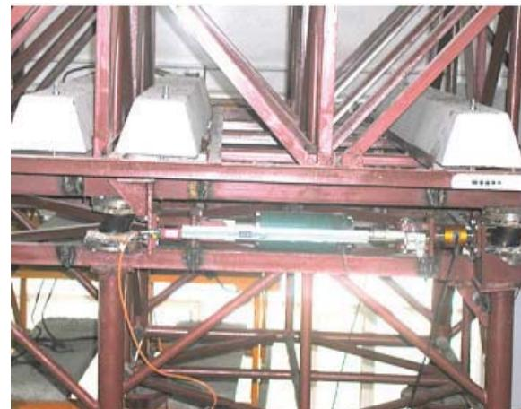
شکل ۱۰. محل نصب میراگر ویسکوالاستیک
