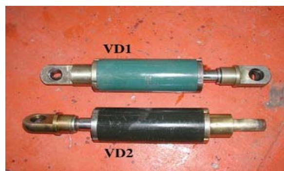
شکل ۷. میراگر ویسکوز
