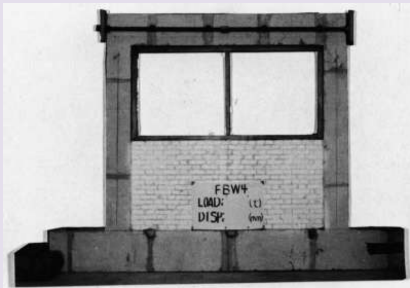
شکل ۲-۱۰- مدل آزمایشگاهی ستون کوتاه
