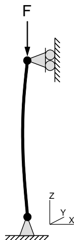
شکل ۲: نحوه شرایط مرزی و اعمال بار، برای حالت بارگذاری محوری
