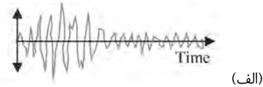
شکل ۱۰.۳ با افزایش فاصله، شدت زلزله کاهش می‌یابد؛ (الف) فاصله‌ی نزدیک، (ب) فاصله‌ی دور
